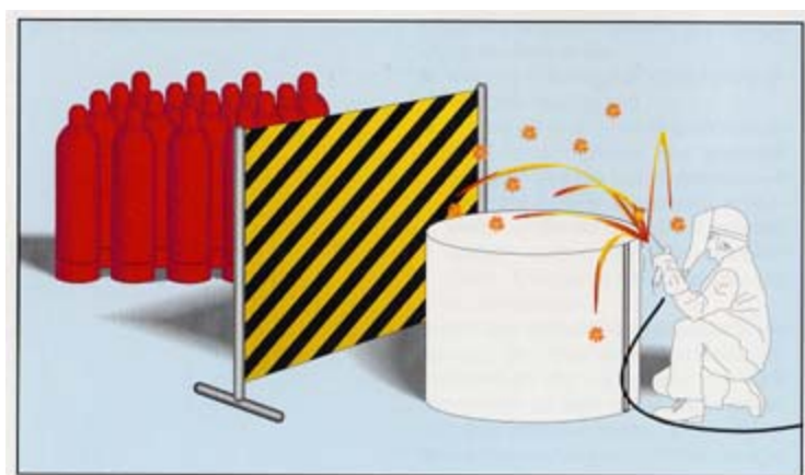
Figur 4.2: Eksempel på afskærmningsforanstaltninger i forbindelse med arbejder, hvor der forekommer gnistregn 4
