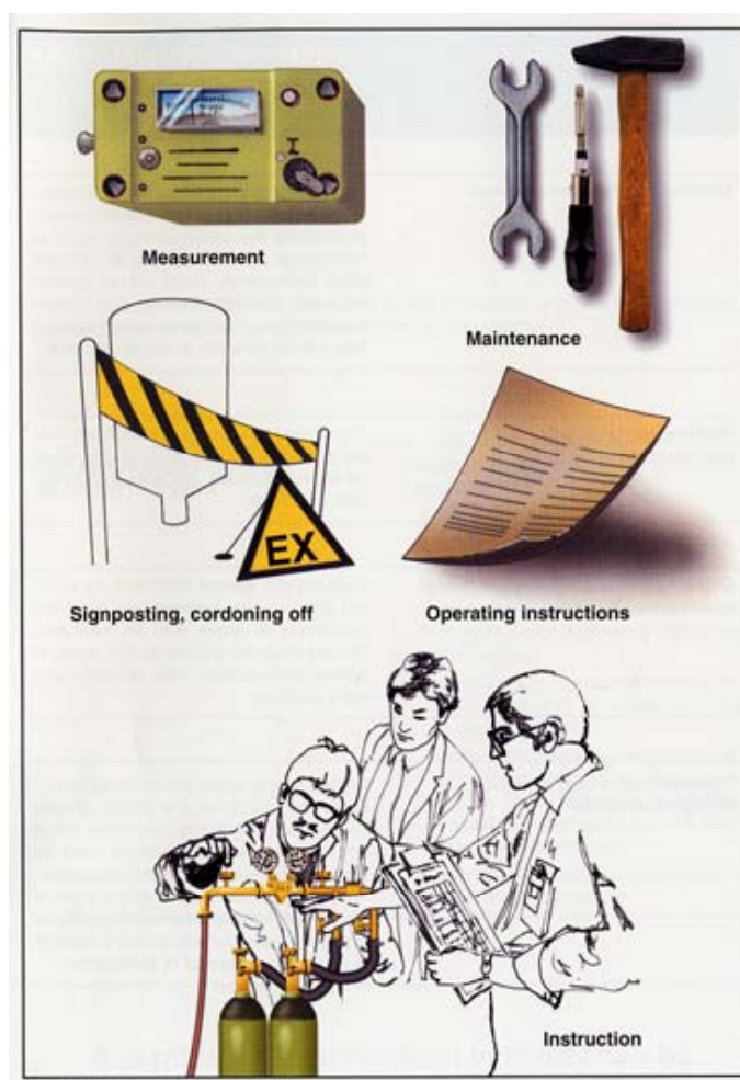
Figur 4.1: Eksempler på organisatoriske foranstaltninger til beskyttelse mod eksplosioner 4
